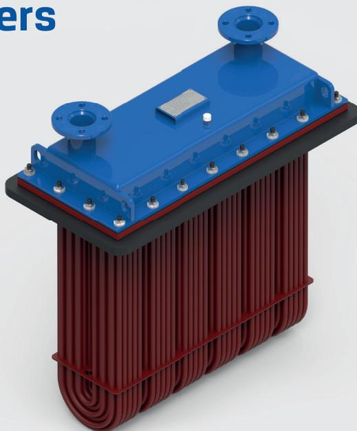
Een U-bundelkoeler is een efficiënt koel systeem voor de scheepvaart. In een U-bundelkoeler wordt het primaire circuit gekoeld met buitenboordwater. Dit maakt wierbakken, afsluiters en een extra zeewaterpomp overbodig. De U-bundelkoeler kan zowel dwars- als langsscheeps in de beunkast geplaatst worden.
